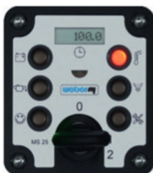
Varování a po uplynutí 3 minut i vypnutí motoru kvůli příliš vysoké teplotě motoru.
