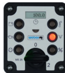
Varování a po 10 minutách i vypnutí motoru kvůli příliš znečištěnému vzduchovému filtru.
